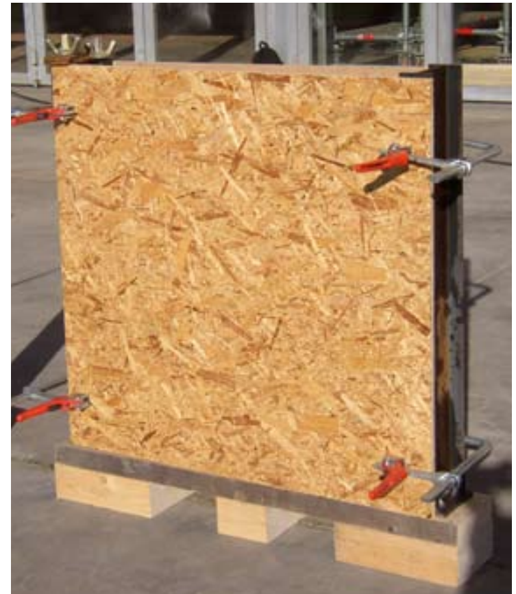
Abb. 115: Schalung für die Versuchswände
